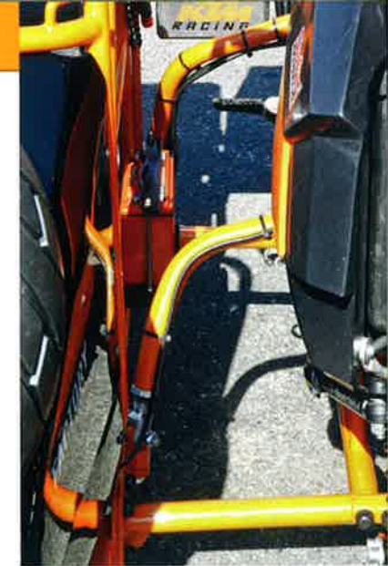
Stabiler Standard: Kati und Beiwagen sind über vier Streben verschraubt.
