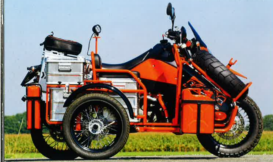
Alles offen: Enduroboot mit Option für Zusatzcontainer im Fußraum.
