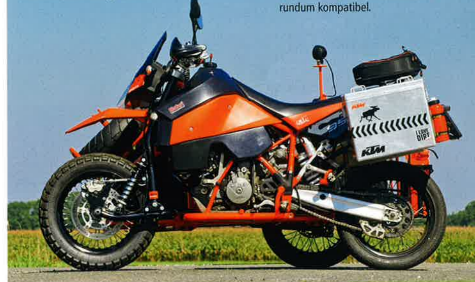
Aufwändig: Mehrfach verschraubter Unterflur-Verstärkungsrahmen.
